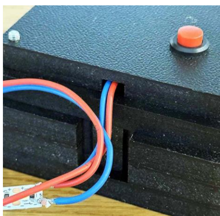
d – Veiller à ce que les fils du ruban à LED passent bien dans la rainure prévue pour leur passage
