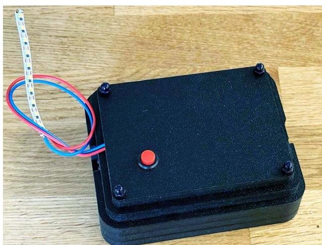
e – On termine par les écrous à chapeau qui vont serrer l'assemblage des 5 plaques
